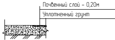
Конструкция газона с посевом трав
